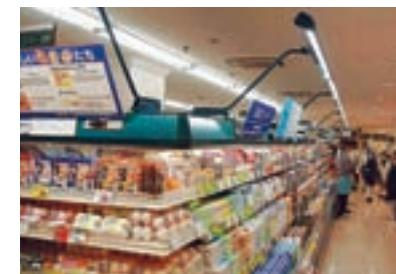
キャンピー照明を採用することで棚毎の照明を減らして、電気使用量の削減を図り大幅な省エネを実現しております。
